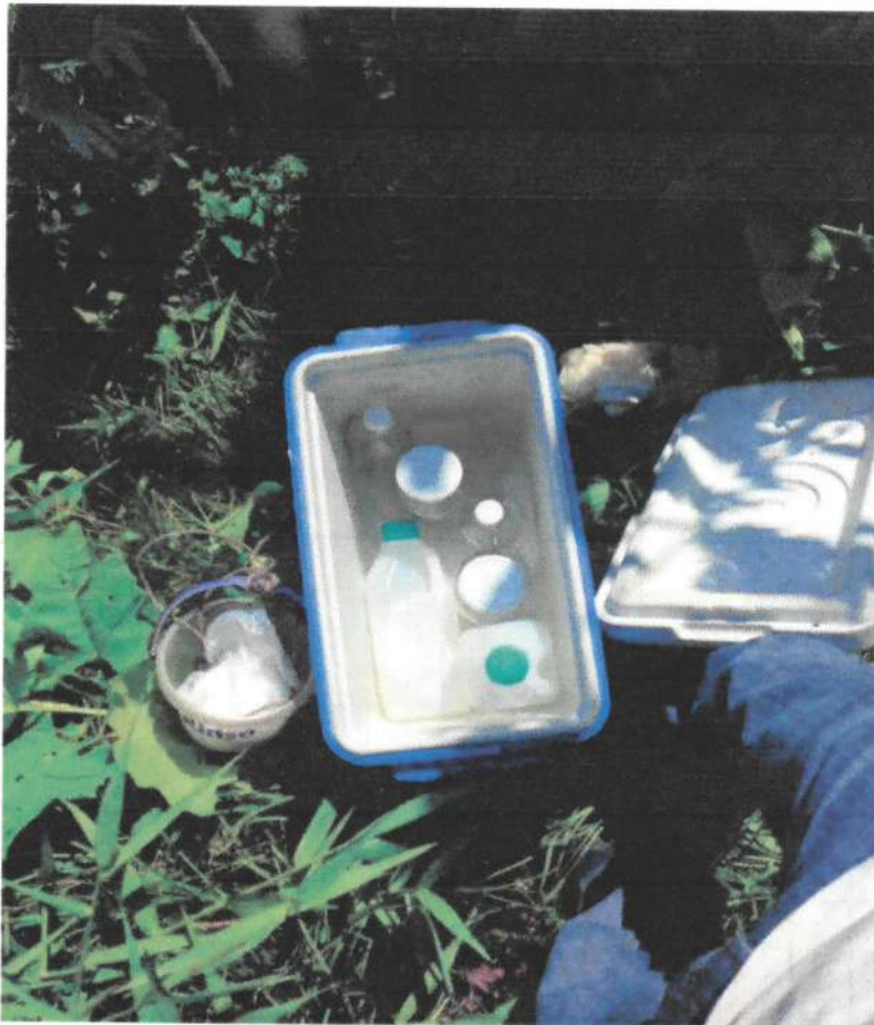
FOTOGRAFÍA 3. Equipo para tomar las muestras de aguas residuales. (Fotografía tomada el día 02/05/2017)
